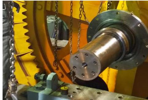
原動滑車の軸とベアリング交換
