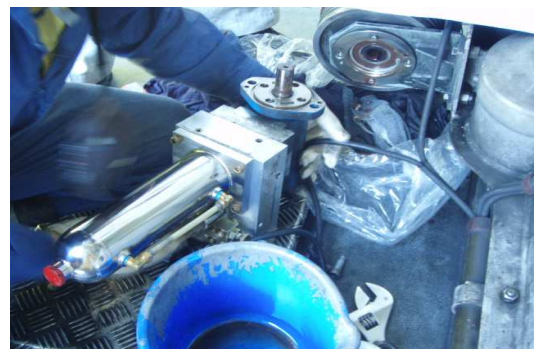
搬器揺れ減衰装置の部品交換
